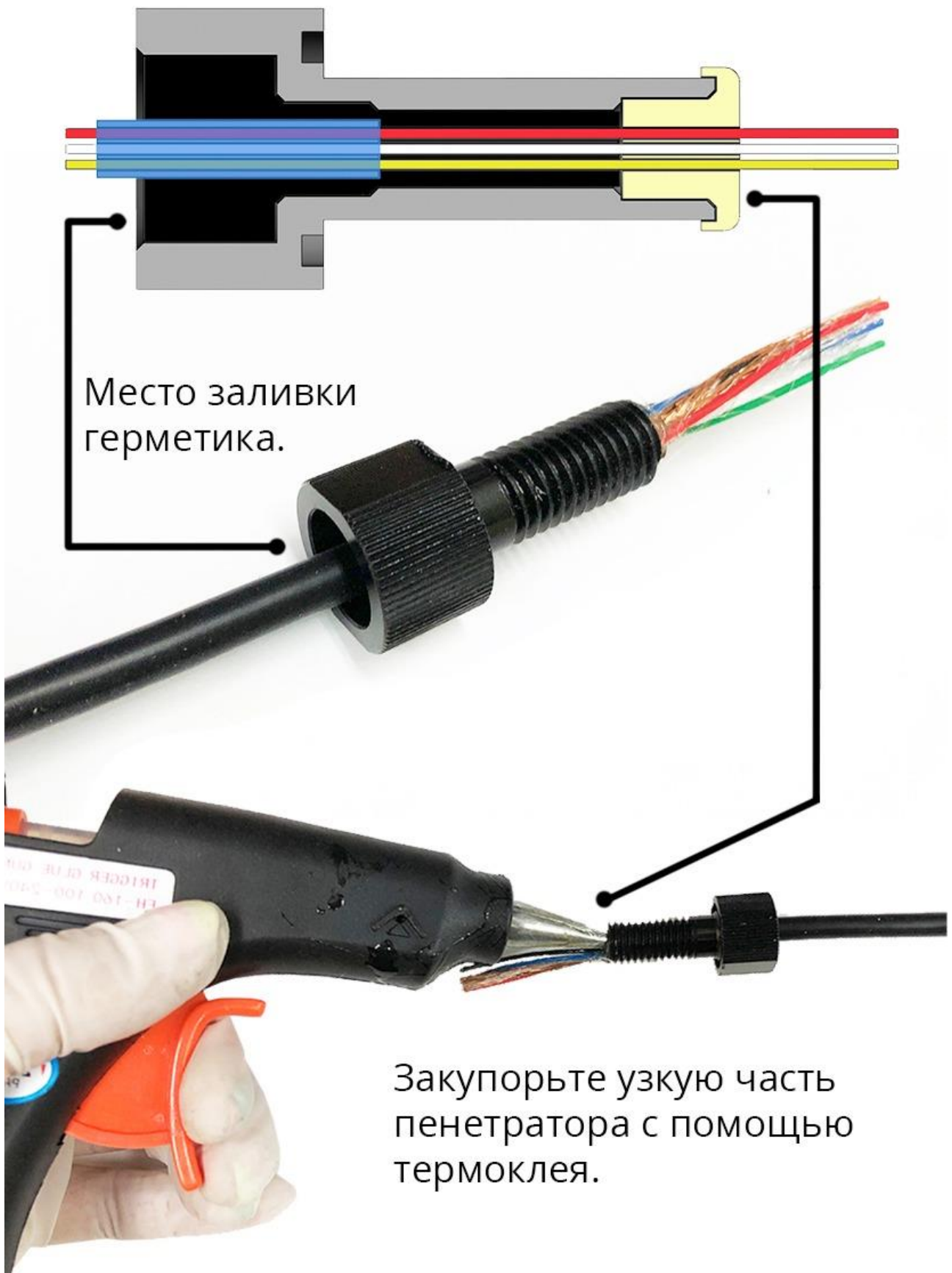
Рисунок 5. Подготовка пенетратора к заливке.
