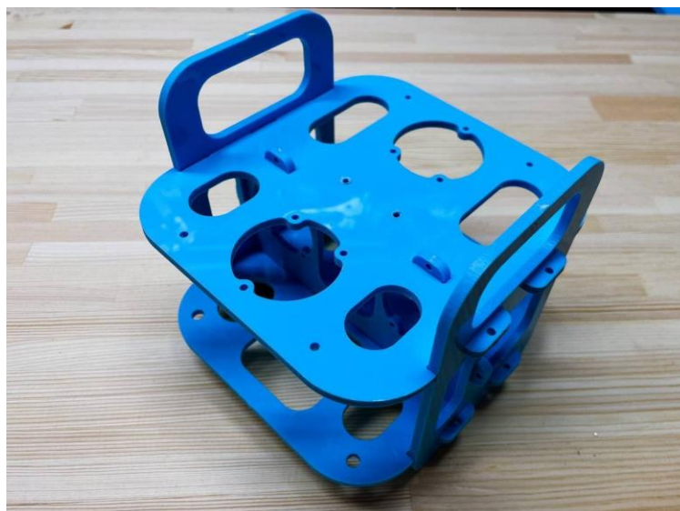
Рисунок 8. Добавлены боковые пластины.
