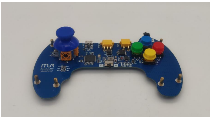
Рисунок 3. Пульт с прикрученными стойками
