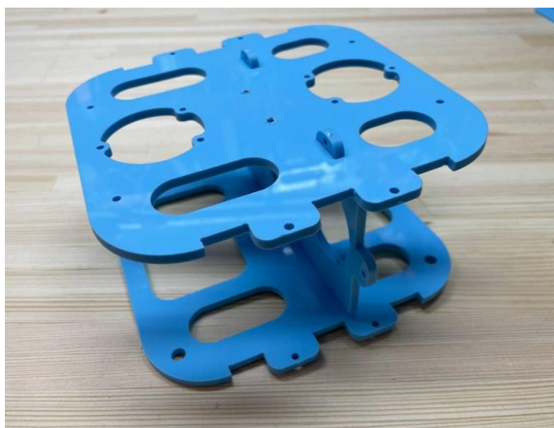
Рисунок 7. Добавлена верхняя пластина.
