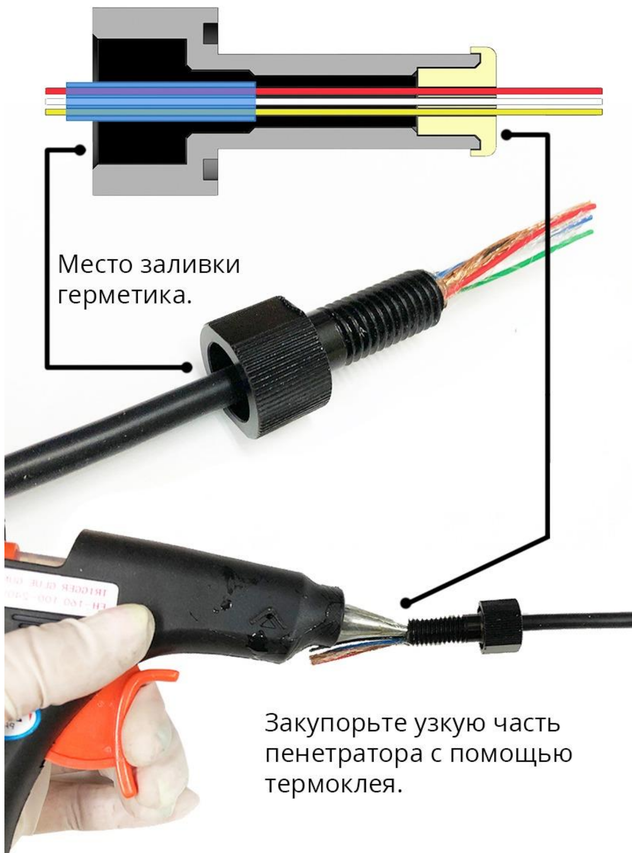
Рисунок 5. Подготовка пенетратора к заливке.
