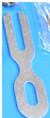
Рисунок 3. Устройство для закручивания гермовводов.
