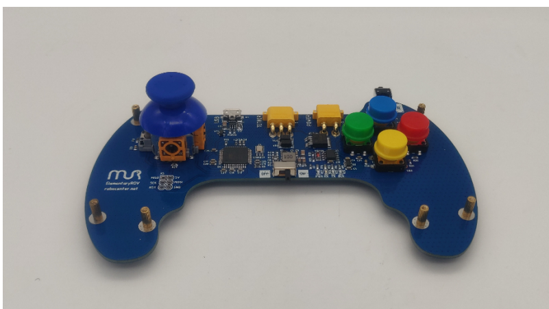
Рис. 4. Пульт с прикрученными стойками
