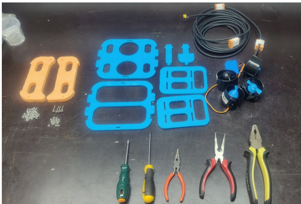
Рис. 6. Элементы конструкции и необходимые инструменты
