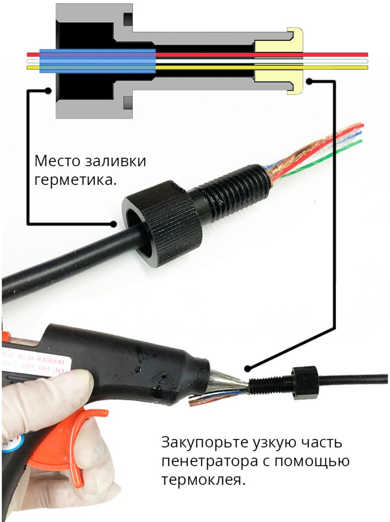
Рис. 12. Подготовка пенетратора к заливке
