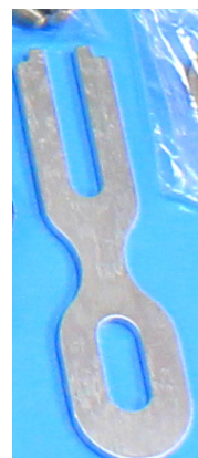
Рис. 10. Устройство для закручивания Гермовводов
